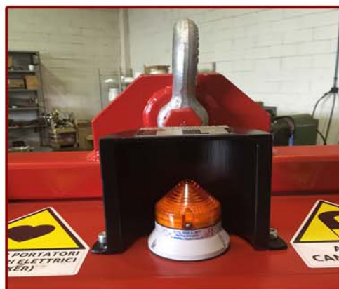
▲ Luz intermitente cuando electroimán magnetiza Flashing light when electromagnet magnetizes
