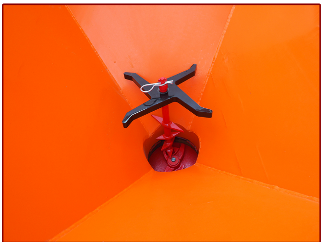
▲ El agitador evita la obstrucción del material. Agitator avoids clogging of material.
