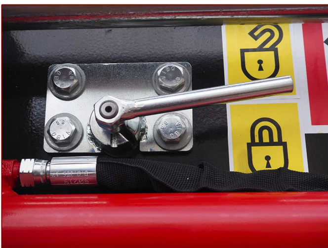
▲ Palanca bloqueo inclinación transversal. Transverse tilt lock lever.
