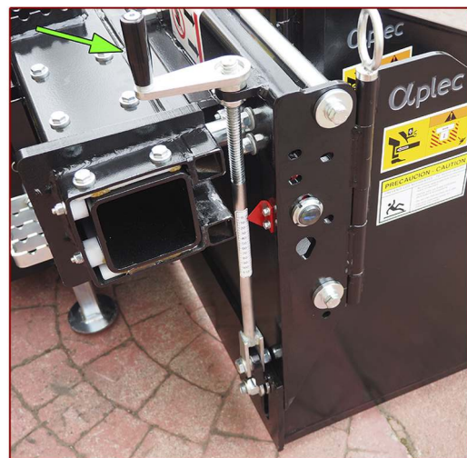
▲ Ajuste mecánico, independiente derecha-izquierda, para regular el espesor de la capa del material a extender (eléctrico opcional). Mechanical adjustment, independent right-left, to regulate the layer thickness of the material to be extended (optional electric).
