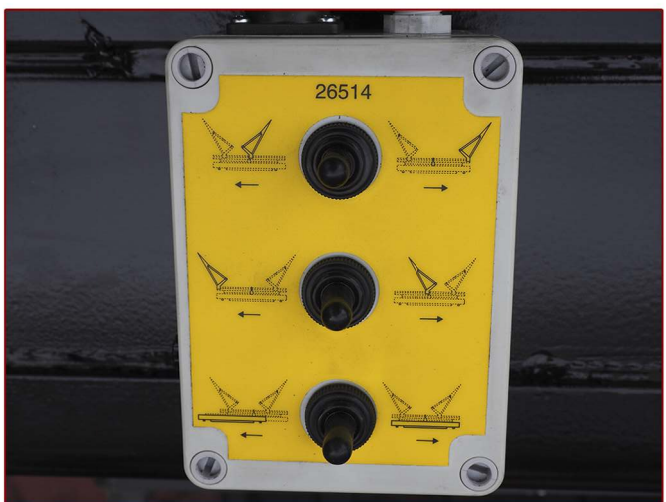
▲ Botonera control de movimientos. Keypad for movements control.
