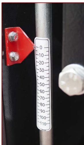
▲ Ajuste mecánico, independiente derecha-izquierda, para regular el espesor de la capa del material a extender (eléctrico opcional). Mechanical adjustment, independent right-left, to regulate the layer thickness of the material to be extended (optional electric).
