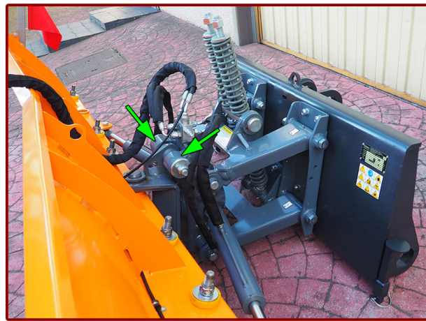
▲ Oscilación lateral con autonivelación y retorno por muelles. Lateral oscillation with self levelling and return by springs.
