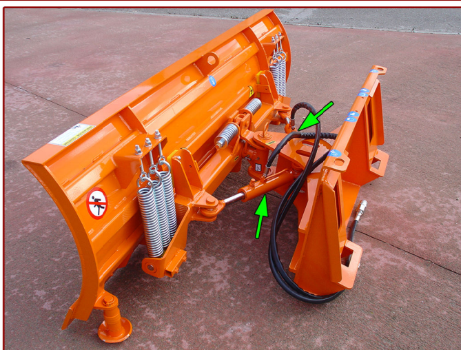
▲ Angulación horizontal hidráulica Hydraulic horizontal angulation
