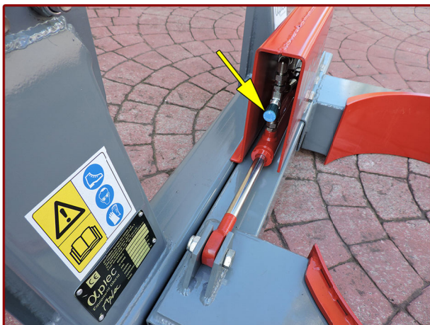
▲ Velocidad de apertura-cierre de las mordazas ajustable Adjustable jaw opening-closing speed
