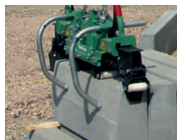
Arcos de apoyo Ayuda para coger de forma rápida y segura los bordillos
