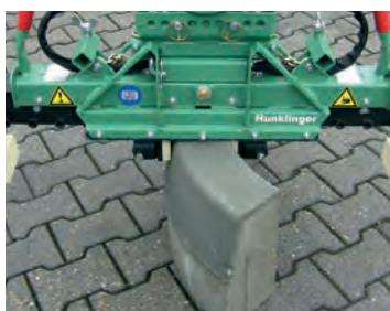
Sujeción transversal Colocación de bordillos con radio o manipulación de bordillos rectos
