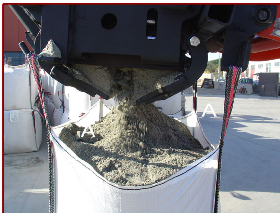
▲ Sistema hidráulico de descarga del material Hydraulic unloading system
