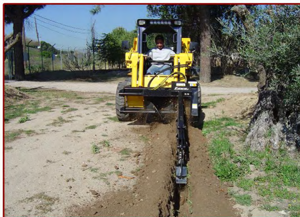
▲ Pluma autoalineable y cadena de excavación ABF anti-flexión atrás. Self-aligning boom and Anti-Back Flex (ABF) digging chain.
