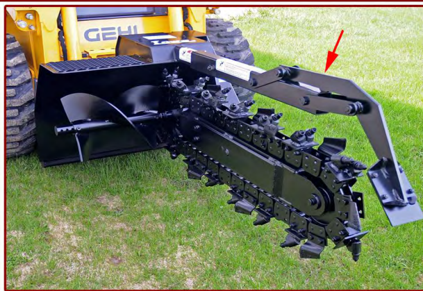
▲ Dispositivo para limpiar el fondo de la zanja. Cleaner to level out the bottom of the trench.
