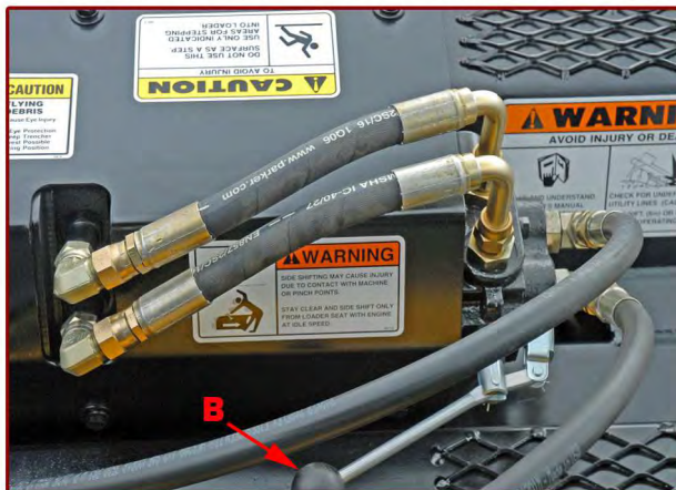
▲ Desplazamiento lateral mecánico (A) para excavar en el centro o a un lado. Hidráulico opcional (B). Mechanical lateral displacement (A) to dig in the center or to one side. Hydraulic optional (B).
