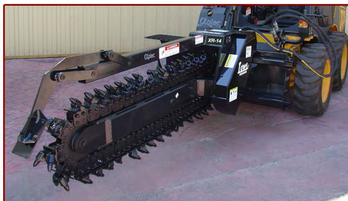
▲ Cadena con picas de carburo de tungsteno. Chain with tungsten carbide picks.
