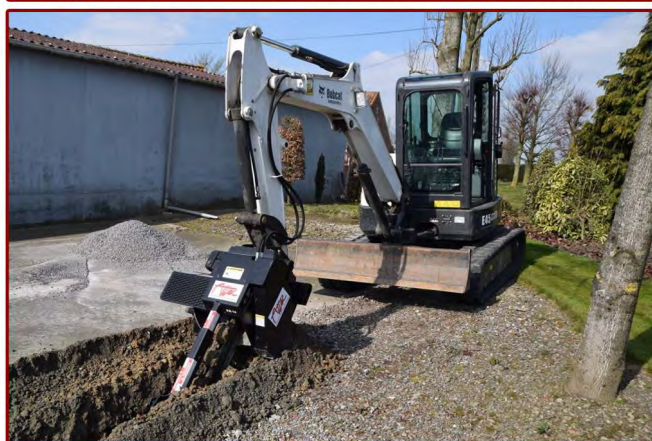
▲ Pluma autoalineable y cadena de excavación ABF anti-flexión atrás. Self-aligning boom and Anti-Back Flex (ABF) digging chain.
