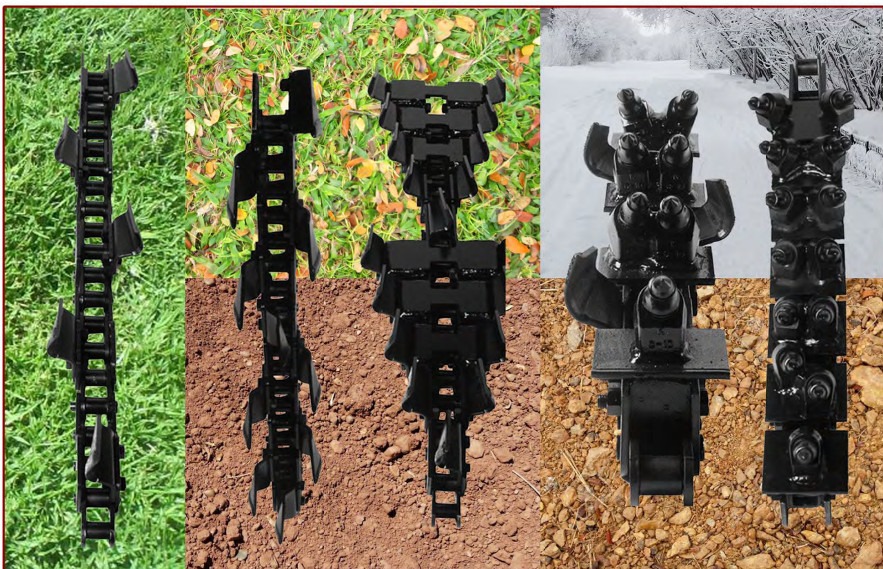
▲ Cadenas con distintas configuraciones de dientes y anchos de trabajo en función del terreno a excavar. Chains with different tooth configurations and working widths depending on the terrain to be excavated.
