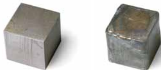
20 milímetros de acero, cortado con un chorro de agua con abrasivo (izquierda); cortado con un rayo láser (derecha).
