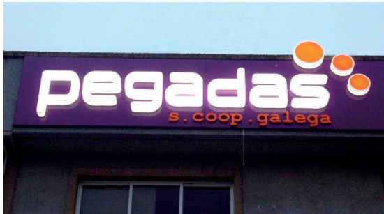
ROTULO CORPOREO EN METACRILATO CON LEDS Y BANDEJAS DE PANEL SANDWICH CON VINILO PEGADAS S.COOP.GALEGA
