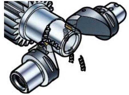
Montaje de la herramienta boca abajo
