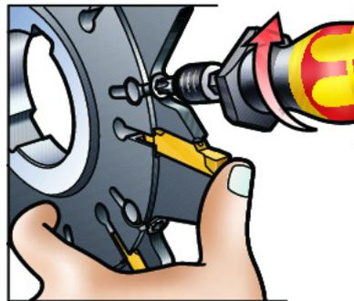
CoroMill 329 dispone de sujeción por tornillo integrada de las plaquitas, que es más segura y estable. Coloque el pulgar sobre la plaquita y empujela dentro del asiento. Utilice un destornillador (Torx Plus) para sujetar (liberar) la plaquita.
