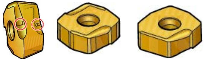
Para generar una buena superficie, es importante garantizar que el avance por vuelta ( $f_n = f_z \times z_n$ ) sea inferior al 80% de la longitud Wiper ( $b_s$  2). Naturalmente, cuanto mayor sea el diámetro de la fresa, mayor será el valor de  $f_n$ , que requiere a su vez mayor  $b_s$ .
