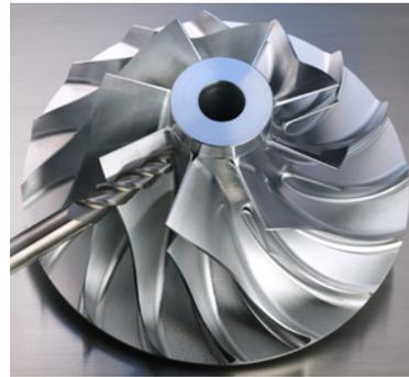
El fresado de un propulsor "bisk" (disco con álabes integrados) es un ejemplo de aplicación de fresado de ángulos cerrados.
