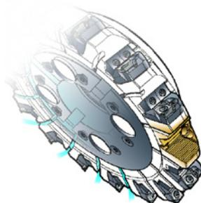
Aflove los tornillos de la cuña y ajuste la altura del cartucho.
