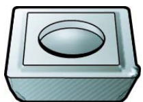
Deformación plástica (plaquita periférica)
