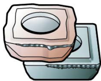
Desgaste en incidencia
