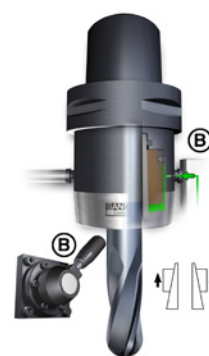
Bomba y válvula en posición B para aflojar la herramienta.
