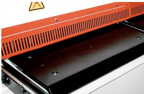
■ Mesa delantera equipada con bolas de transporte para facilitar el posicionamiento y evitar rozaduras en chapas de inoxidable.
