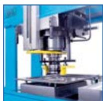
FDM-80/3 E dotada de tres cabezales independientes.
