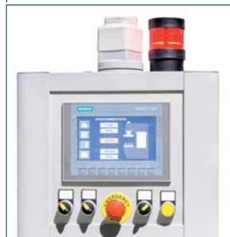
PLC SIEMENS mod. SIMATIC S7 1200 con pantalla táctil de 7" mod. KTP-700.
