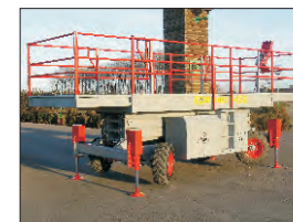
Plataforma bajada con los 4 estabilizadores bajados
