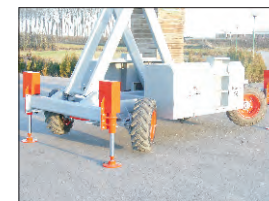
Plataforma subida con los 4 estabilizadores bajados
