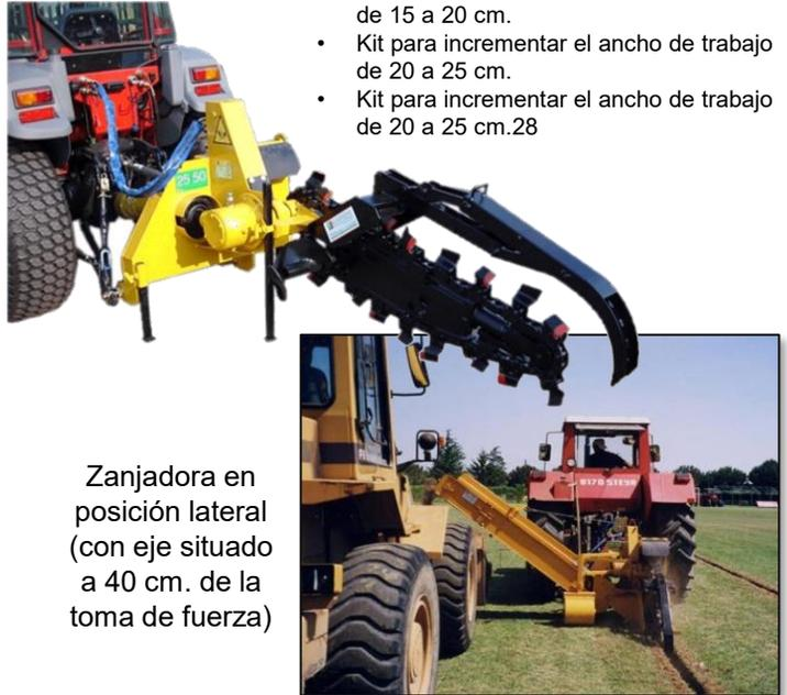
Zanjadora en posición lateral (con eje situado a 40 cm. de la toma de fuerza)
