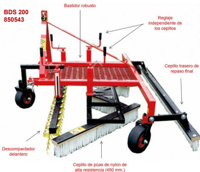
Para la descompactación rápida (y frecuente) en campos de césped artificial, eficiente sobre todo tipo de campos, con caucho granulado o arenoso
