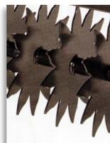
**TA 500:** Aireador de arrastre sobre 2 ruedas laterales de 100 cm. de ancho de trabajo mediante 70 cuchillas (10 estrellas de 7 cuchillas cada una) de 15 cm. de largo, profundidad de trabajo de 8 cm. (ancho total de 130 cm.) y 35 kg. de peso.
