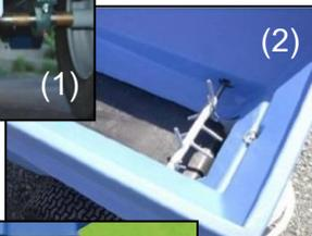
(1) Su sistema de difusión de doble disco a rotación inversa asegura un esparcido uniforme, incluso con materiales pesados como arena o ciertos productos para esparcido
