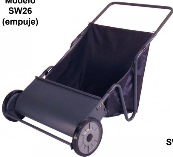
Barredora de empuje de 66 cm. de ancho de trabajo mediante 2 cepillos de 25 cm. de diámetro cada uno, altura de trabajo regulable, capacidad de recogida de 190 lt., chasis de acero y ruedas semi-neumáticas con llantas de aluminio de 20 cm. de diámetro.
