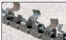
**Cadena con cuchillas (para ancho de zanja de 11 cm.)**
