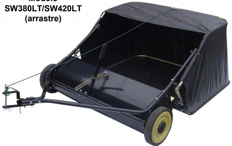
Barredora de arrastre de 97 cm. (SW380LT) o 107 cm. (SW420LT) de ancho de trabajo, capacidad de recogida de 339 lt. (SW380LT) o 368 lt. (SW420LT) y ruedas de 25 cm. de diámetro.
