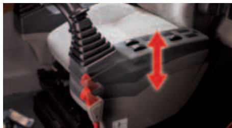
Control de movimientos (joystick) ajustable en altura
