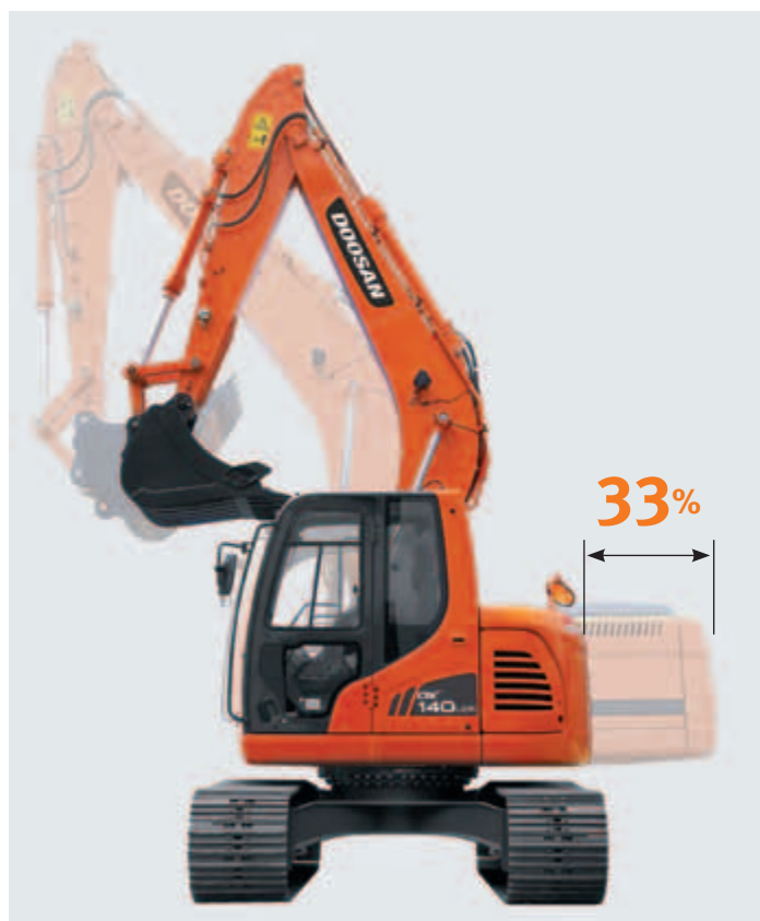
Voladizo trasero sobre la cadena de solo 15,5 a 23,5 cm
