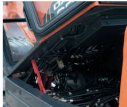
Cabina abatible para un fácil mantenimiento
