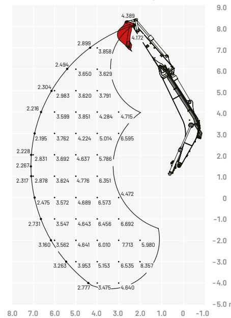
Brazo articulado (hacia delante, pala dozer levantada)
