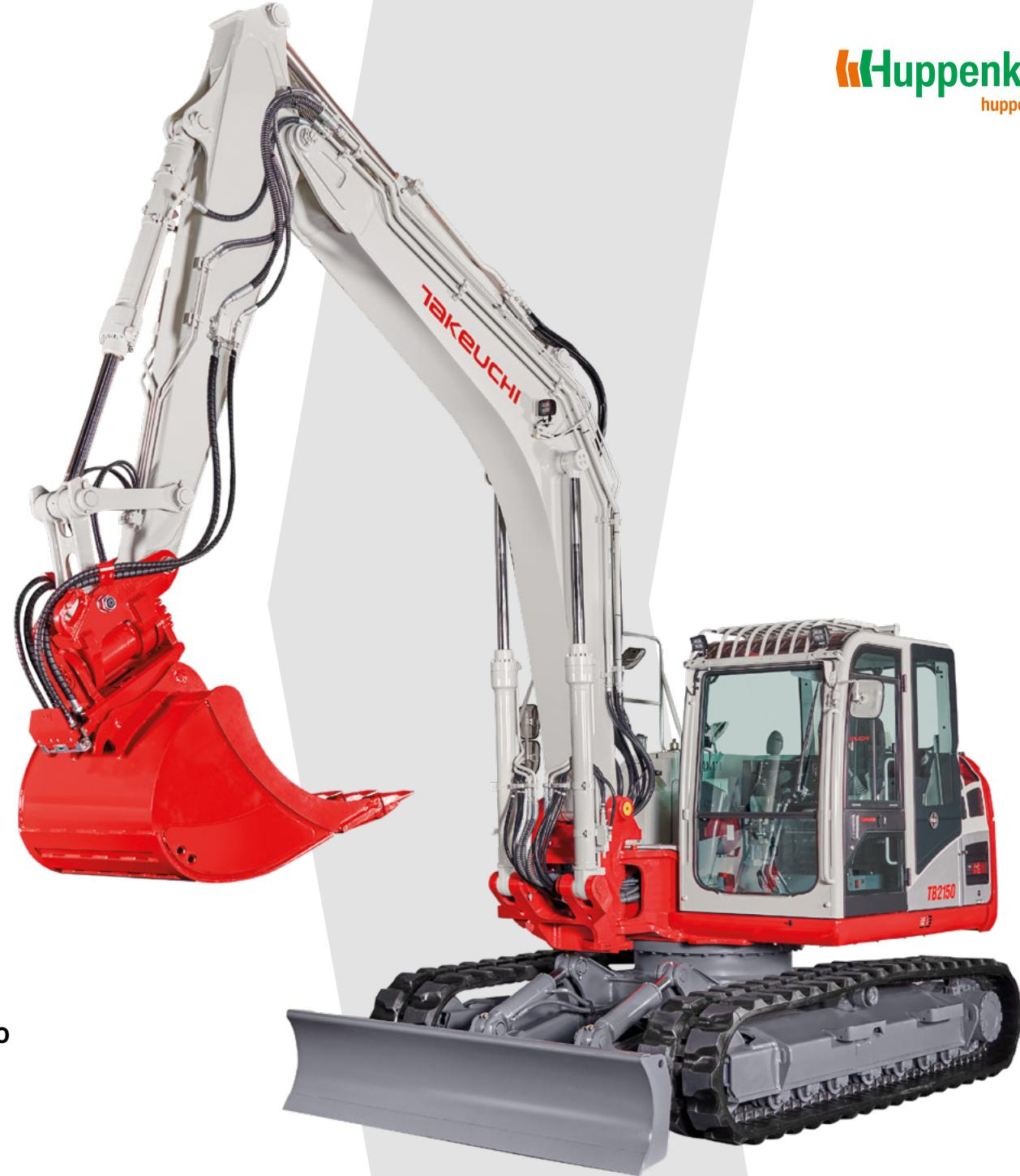
**La excavadora compacta TB2150, de parte trasera convencional y con giro de brazo, permite excavar fácilmente en paralelo a una pared o un muro.** La TB2150, de 16 toneladas, es la mayor de la familia TAKEUCHI, sin embargo puede utilizarse como una miniexcavadora.
