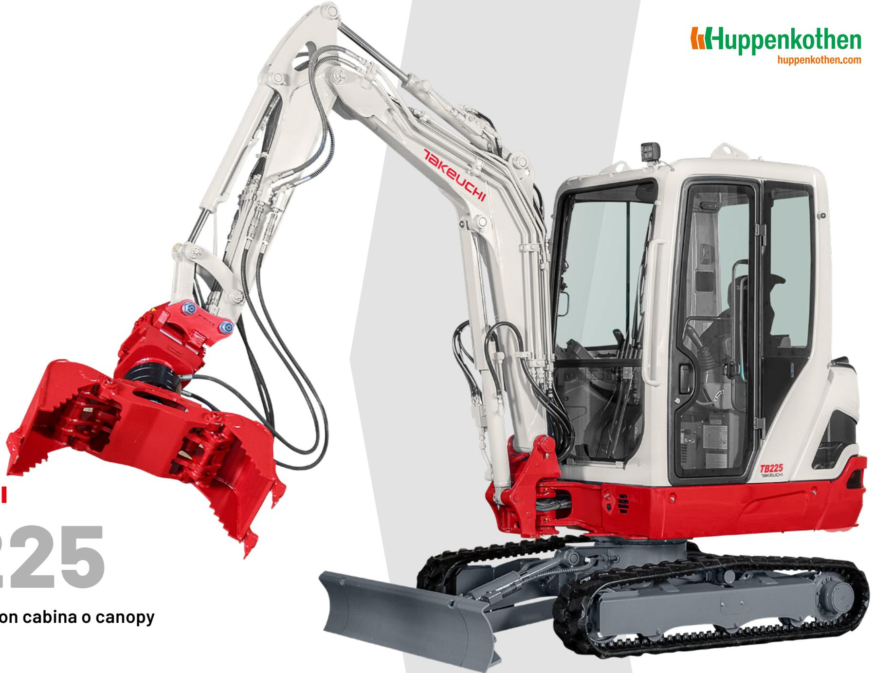
La miniexcavadora Takeuchi **TB225** tiene el mejor rendimiento de motor de su clase. Sus extraordinarias capacidades de elevación, su excelente profundidad de excavación y su gran estabilidad hacen de la TB225 una herramienta versátil para trabajos exigentes.
