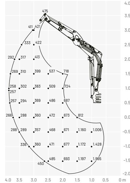
Canopy (hacia delante, pala dozer levantada)
