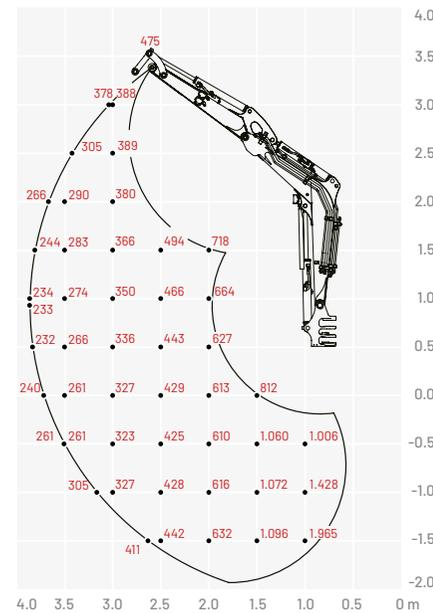
Las cargas indicadas en las tablas no superan el 87% de capacidad de elevación hidráulica o el 75% de carga de vuelco.
