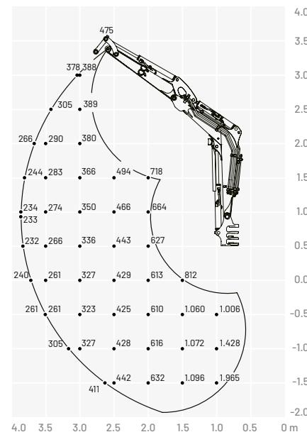
Las cargas indicadas en las tablas no superan el 87% de capacidad de elevación hidráulica o el 75% de carga de vuelo.
