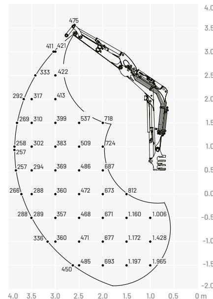
Canopy (hacia delante, pala dozer levantada)
