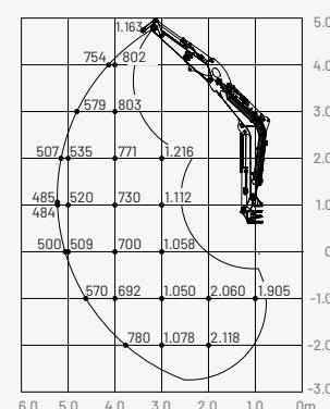
Las cargas indicadas en las tablas no superan el 87% de capacidad de elevación hidráulica o el 75% de carga de vuelco.
