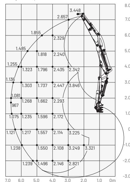
Las cargas indicadas en las tablas (a la izquierda) no superan el 87% de capacidad de elevación hidráulica o el 75% de carga de vuelco.
