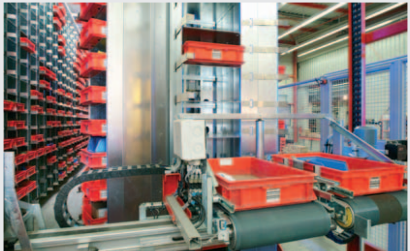
Extracción de cubetas y transporte vertical mediante elevadores fijos. La eliminación de los transelevadores permite reducir la distancia entre los carruseles y en consecuencia ayuda a ahorrar espacio.
