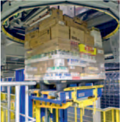
Los palets llenos se bajan hasta el nivel de la salida de mercancías, donde los envuelve automáticamente una enfardadora
