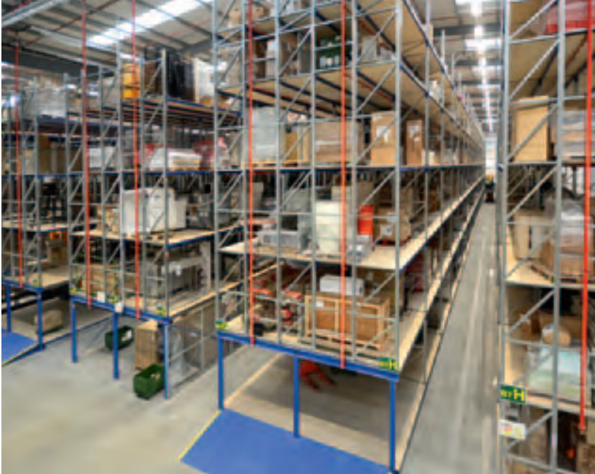
El estante elevado especial para artículos grandes se puede operar mediante un vehículo especial que eleva también al operario
