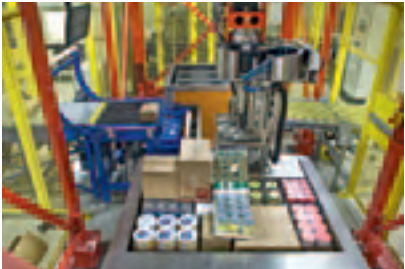
El sistema SCP ha sido diseñado para tener un rendimiento de hasta 74 palets por hora con 5.350 cajas
