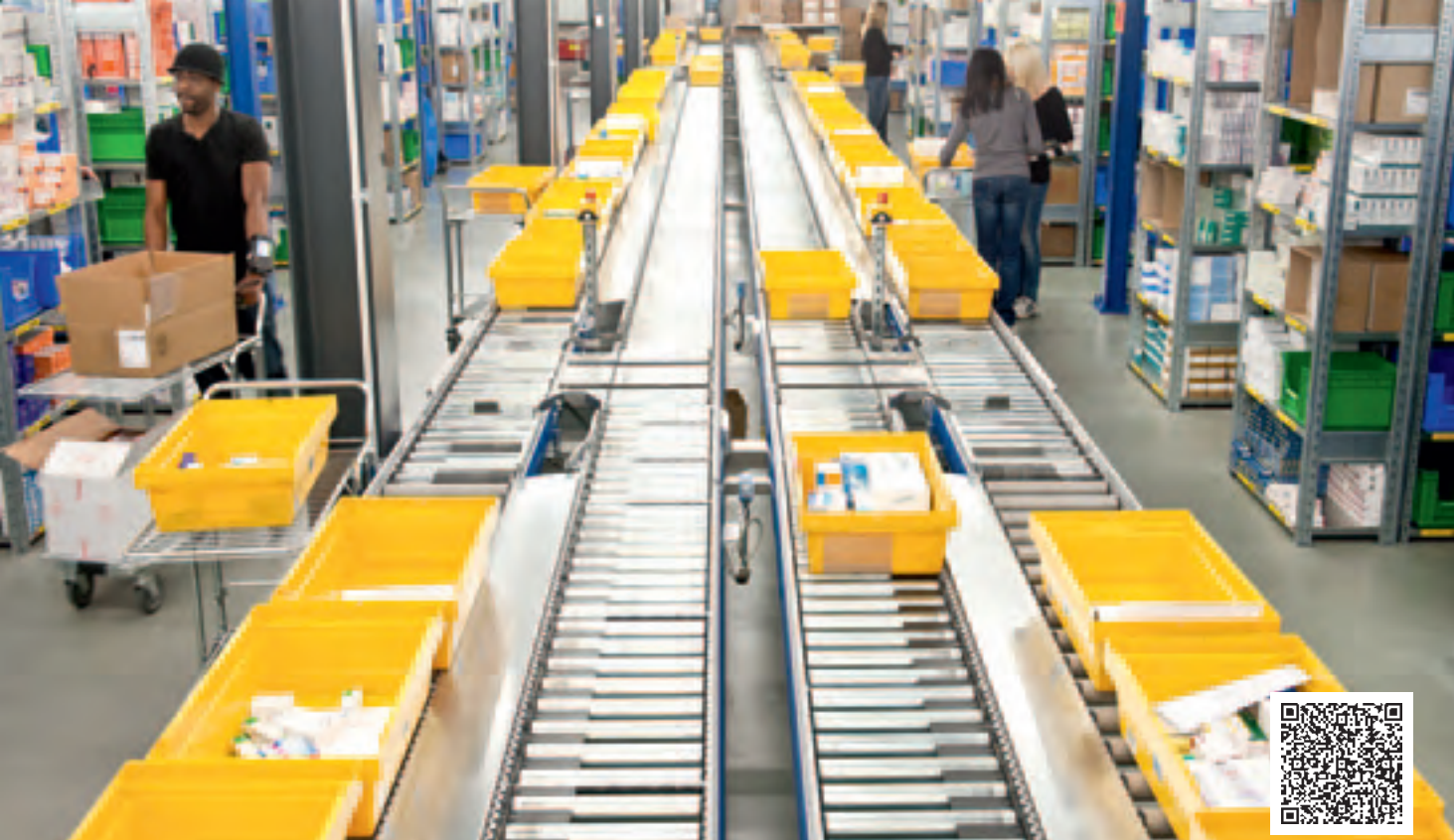
En el trayecto de técnica de transporte de 80 m de largo hay 8 áreas de preparación de pedidos conectadas
