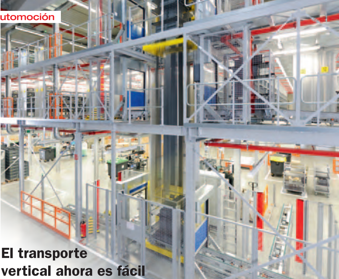
El sistema Schaefer Vertical System se puede utilizar en paralelo para el almacenaje y el desalmacenaje.
