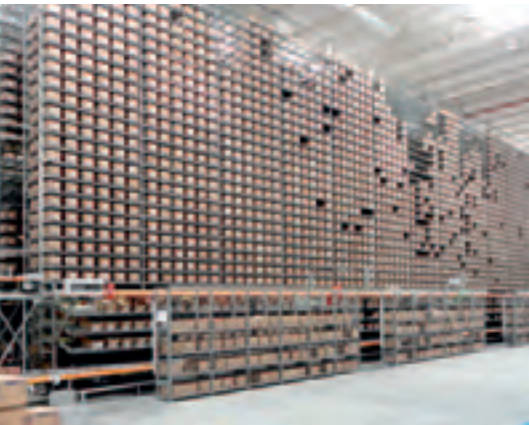
El almacén automático de piezas pequeñas garantiza un rendimiento de hasta 1.500 pedidos por hora
