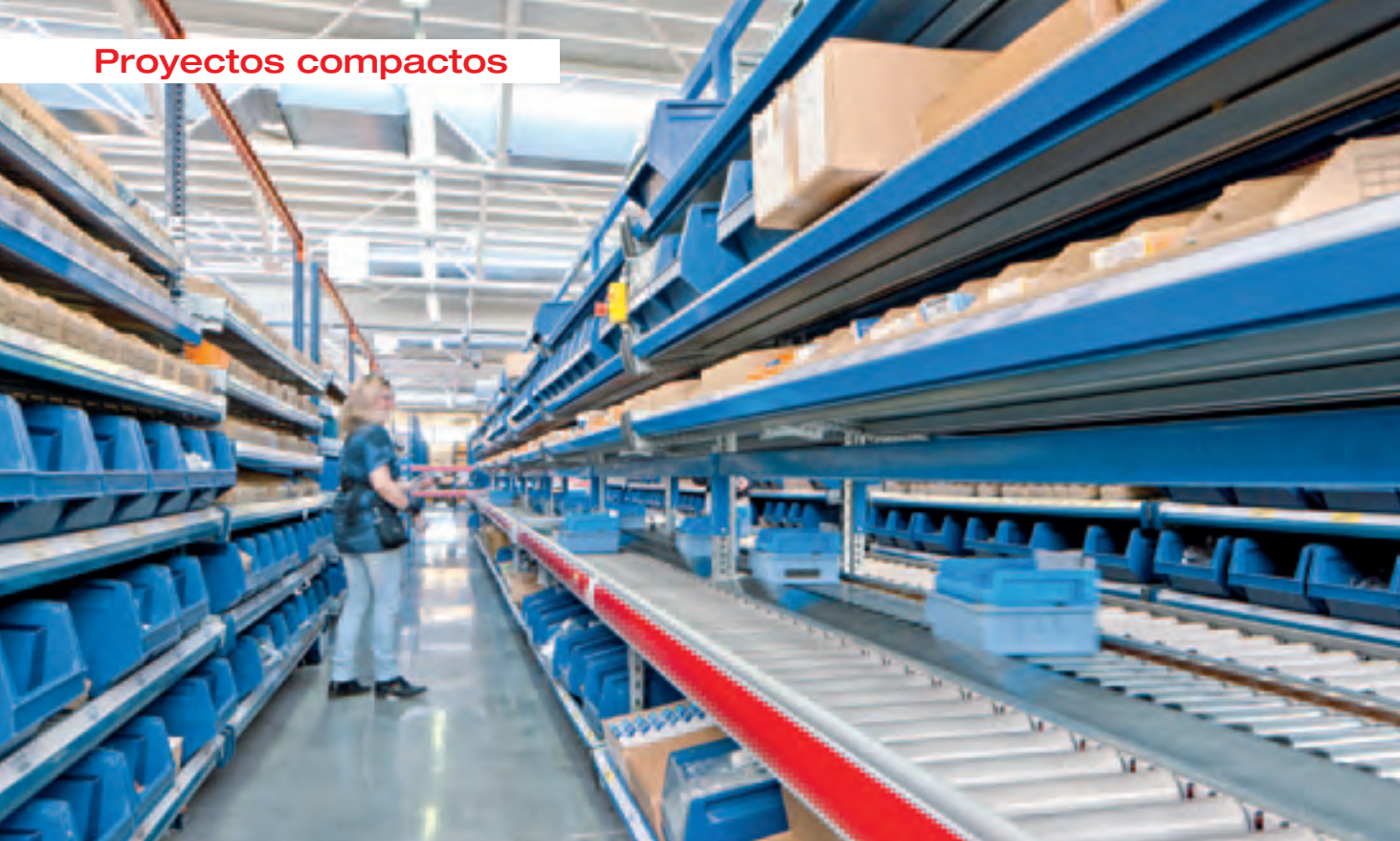
Una de las tres zonas de preparación de pedidos con estanterías dinámicas de doble acceso
