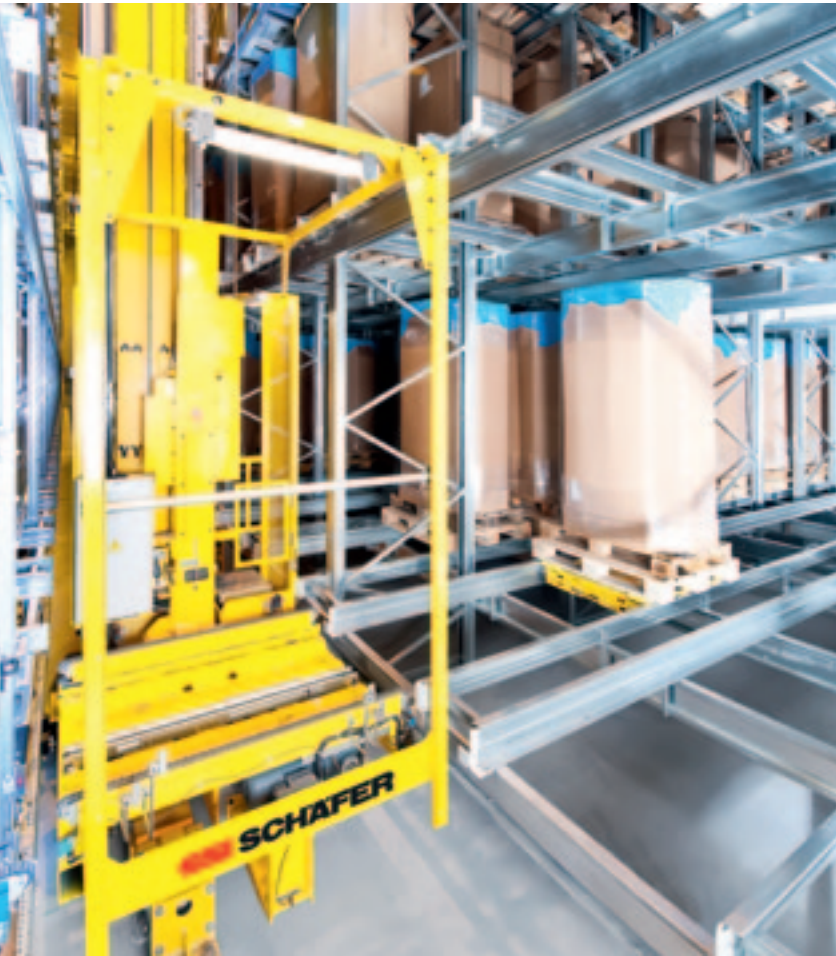
Combinación especial del transelevador Schaefer Compact Crane y Schaefer Orbiter System como solución shuttle
