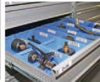
Los contenedores insertables sirven también para el transporte seguro de las herramientas.
