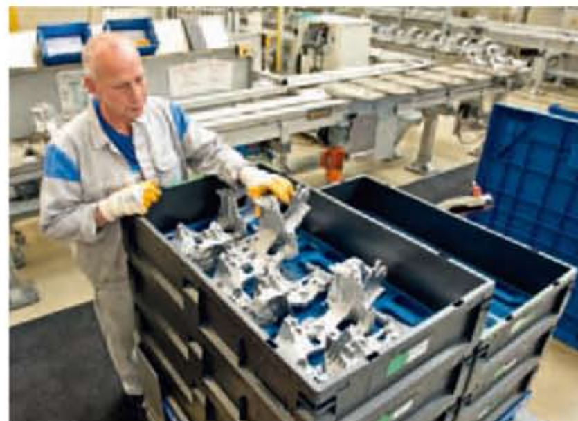
Para la manipulación manual están integradas asas de transporte en el borde de apilado en los lados frontales del contenedor QX
