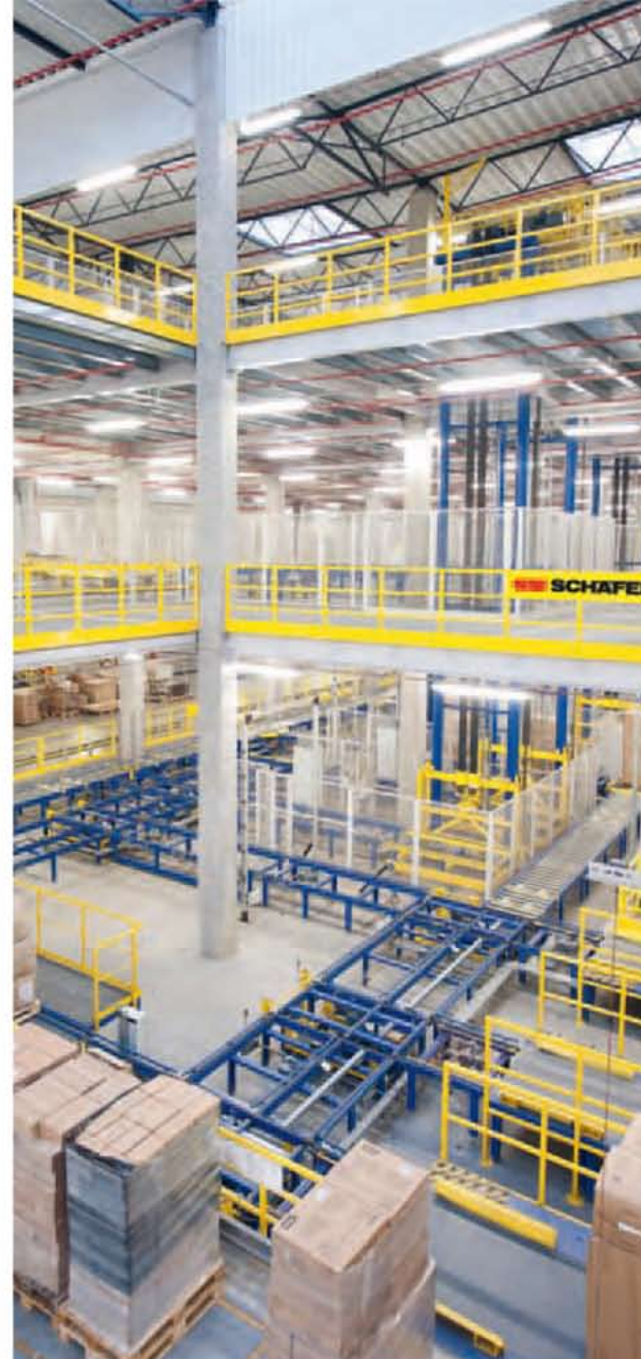
Los transportadores verticales transportan los palets a las plantas superiores para la entrega a la electrovía de palets
