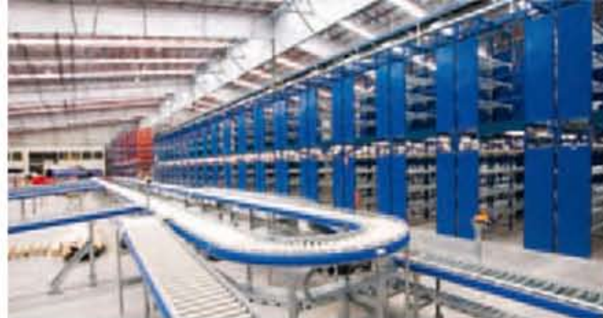
Vista del sistema de transporte continuo, la instalación de estanterías para cargas ligeras de dos plantas y en el fondo la estantería de paletización
