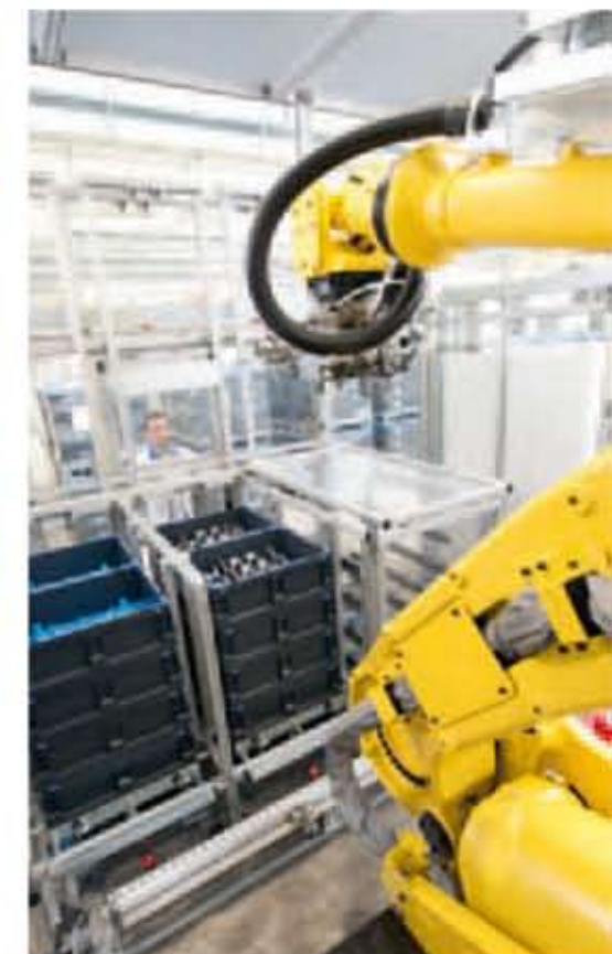
Un robot embala el cigüeñal en el contenedor QX
