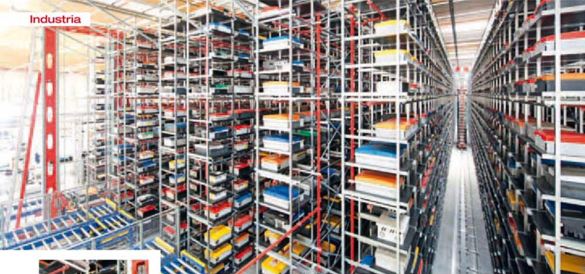
Almacén miniload automático con concepto de emergencias integrado que permite una distribución variable de los pasillos.
