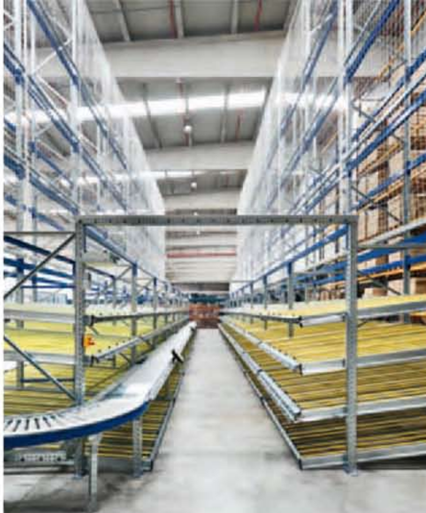
En la estantería por gravedad para bultos están disponibles 216 ubicaciones de picking para artículos de rotación baja
