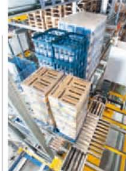
En un único ciclo el dispositivo tomacargas retira 2 cuartos de palet o 1 medio palet de las ubicaciones
