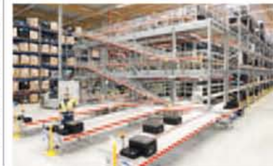
Altillero con estanterías por gravedad para bultos integrados
