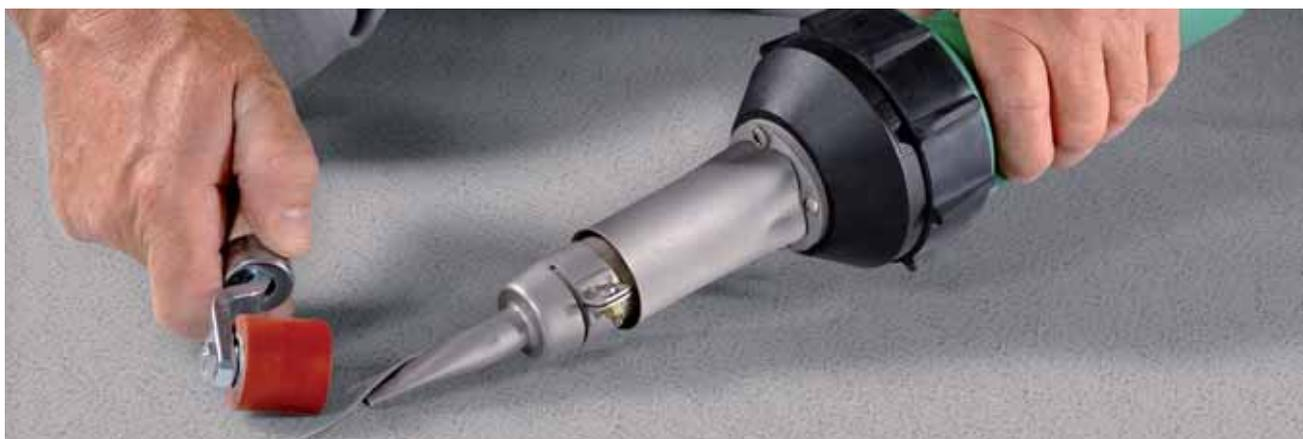
En cada sistema de cubiertas instalado, las membranas monocapa Sika de PVC y de FPO se deben siempre soldar entre sí de forma segura con unos equipos de soldadura por aire caliente especiales. Se emplean los siguientes métodos para la soldadura- soldadura manual y automática.
