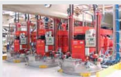
Los revestimientos de poliuretanos de Sika se fabrican en plantas automatizadas con materias primas medidas y dosificadas de forma electrónica en mezcladoras de acero inoxidable. Cada lote de producción tiene un motor potente, con su propio sistema de calefacción y enfriamiento y su sistema de descarga y limpieza automática. A continuación, los productos se envasan en botes de acero.
