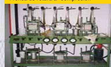
Impermeabilidad al agua. Ensayo con agua bajo presión 6
