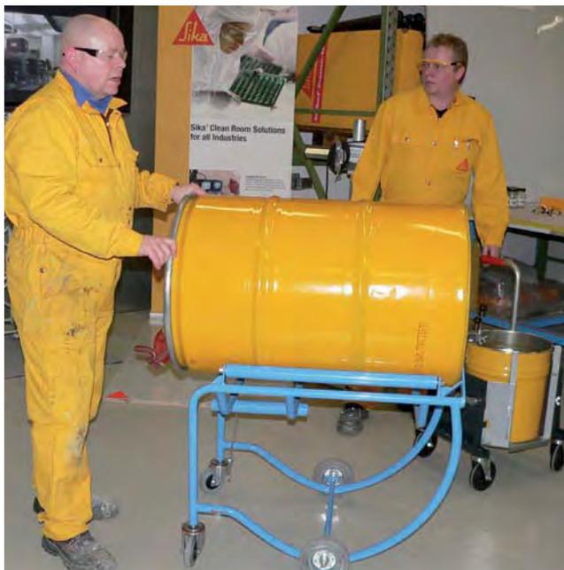
Carro de transporte de bidones para el manejo de los bidones conjuntamente con el carrito transportador.
