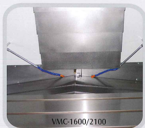
Dispositivo trasero de autolimpieza
