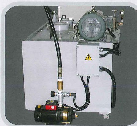
Refrigeracion interna de la hta. con deposito individual
