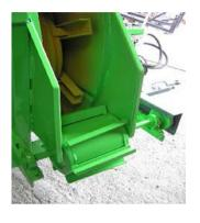
Esparcidor de turbina con rotor de cuchilla y cuchillo raspador.
