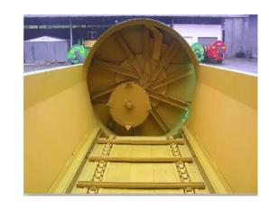
Transportador hidráulico de cadena con velocidad ajustable + válvula antishock.
