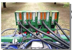
Monitoreo de flujo: Cada cabezal CDA tiene monitor de flujo individual e indicador de luz
