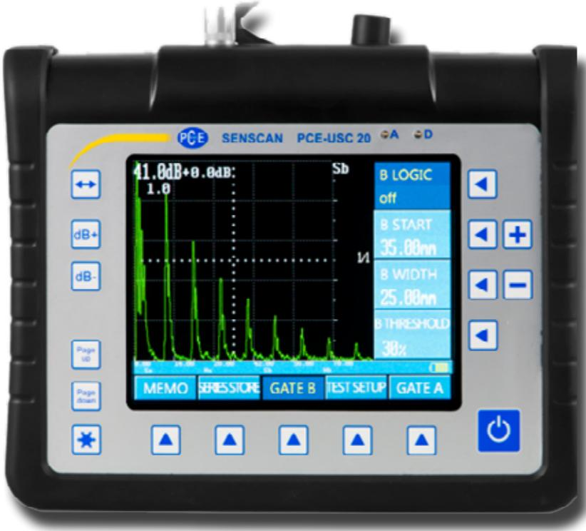
El detector de fallas por ultrasonido sirve para el ensayo de materiales no destructivo. El detector de fallas envía a través del cabezal ondas ultrasónicas al objeto a medir. El ultrasonido rebota y se esparce cuando alcanza superficies límites de diferentes materiales con una densidad diferente. Una vez detectado el tiempo de recorrido del ultrasonido a través de la pieza de ensayo puede comprobar soldaduras, medir espesores y localizar fallas.
