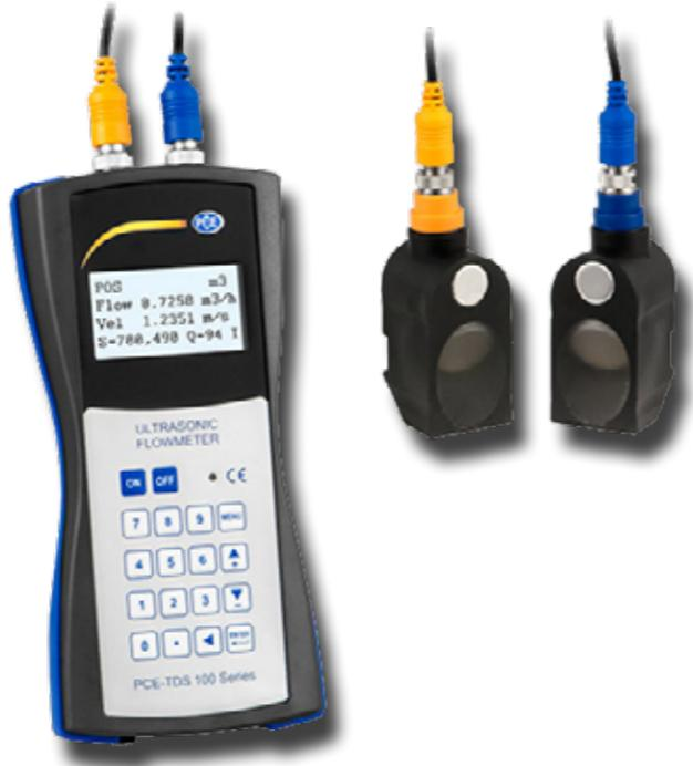
El caudalímetro por ultrasonido se usa para mediciones de control o para detectar de forma rápida el caudal en una tubería, por lo que se trata de un sistema de medición portátil y de fácil instalación. El caudalímetro por ultrasonido trabaja en base a la metodología de tiempo de tránsito. El principio de medición del caudalímetro es muy sencillo. En una medición diagonal en un tubo se necesita menos tiempo que en una medición contracorriente.
