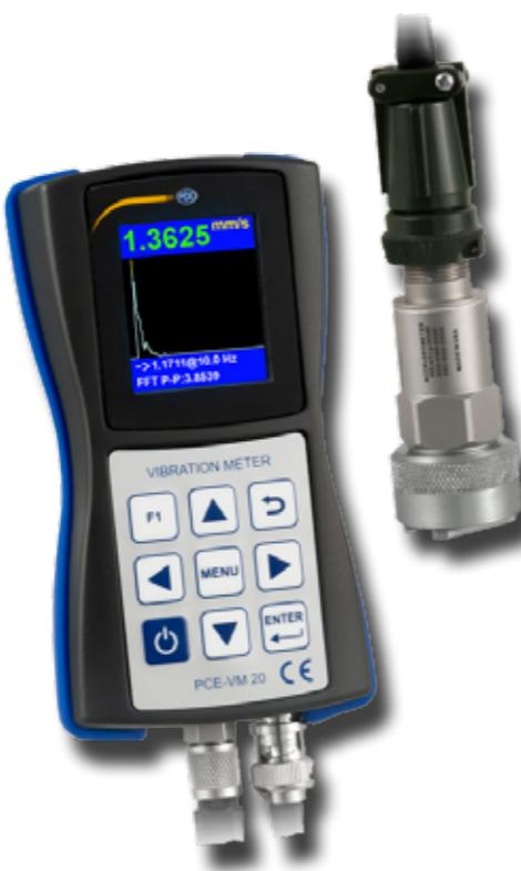
El vibrómetro PCE-VM 20 es un dispositivo compacto para la valoración directa del comportamiento vibratorio de una máquina. El dispositivo mide varios parámetros de vibración: aceleración, velocidad y desplazamiento. El análisis FFT en tiempo real integrado, permite analizar y determinar el estado de una máquina mientras realiza la medición.
