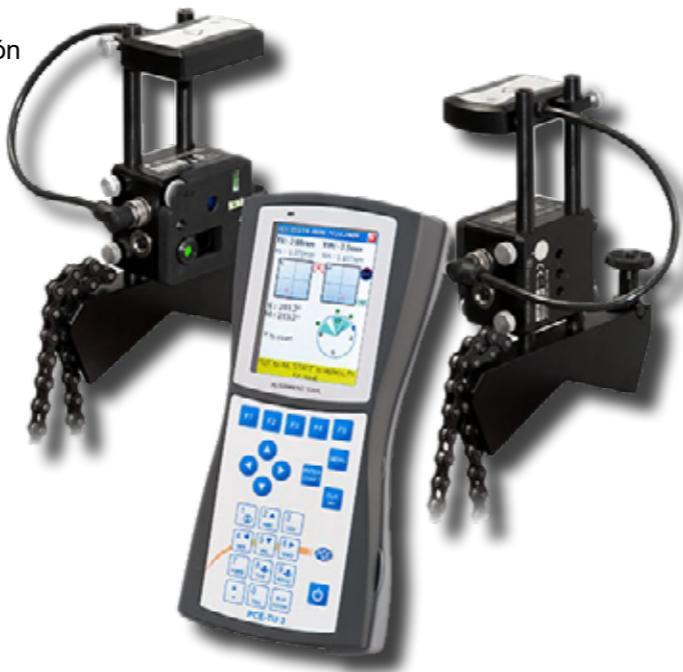
El PCE-TU 3 es un sistema para alinear y comprobar de forma rápida las uniones de ejes entre máquinas y motores. Mediante dos sondas de medición láser, que se montan sobre los ejes, el sistema de alineación mide el desplazamiento horizontal/vertical y la desviación angular. El sistema de alineación considera también otros parámetros como las tolerancias o las dilataciones térmicas, así como simular discos de separación.
