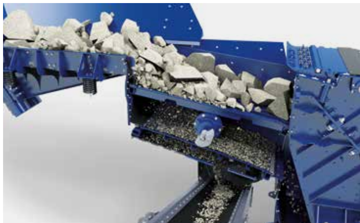
Precriba de cubierta doble de oscilación independiente
