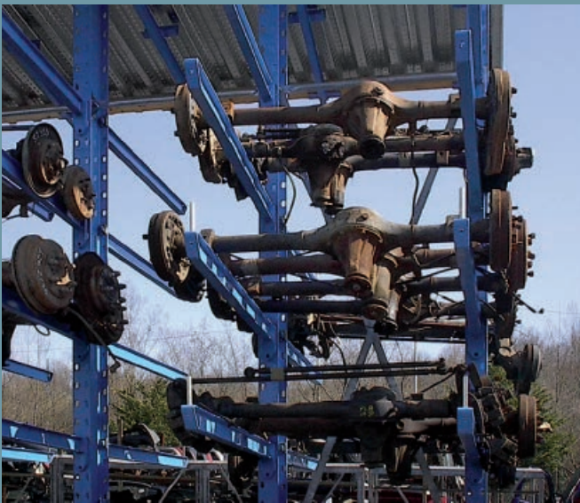
Almacenar varios ejes pesados uno detrás del otro en un nivel de forma clara. Con ello se simplifica la localización rápida de la mercancía deseada y su manipulación.
