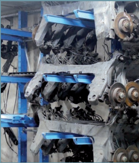
Posibilidades de almacenamiento de ejes de vehículos en estanterías cantilever. Las distancias entre los soportes son variables y ajustables en altura en los niveles de almacenamiento.
