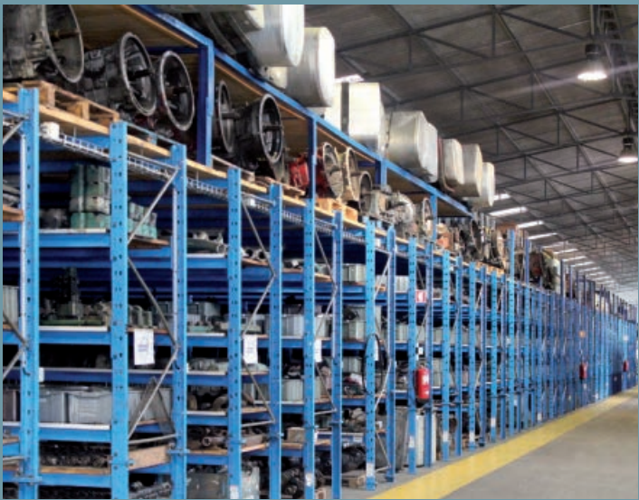
Combinación de estanterías robustas de paletización para el almacenamiento de repuestos o artículos pequeños, dedicando el nivel más alto al almacenamiento adicional para componentes voluminosos.
