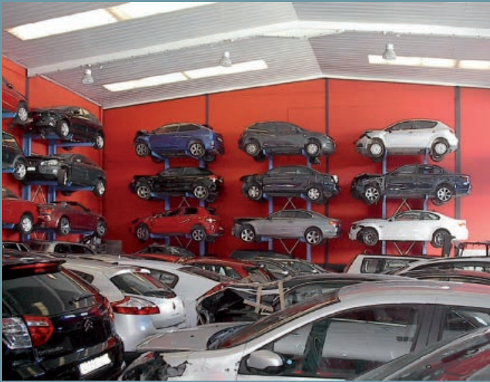
Almacenamiento de varios vehículos uno encima del otro. Aprovechamiento de la altura del espacio disponible y la superficie de la pared existente.
