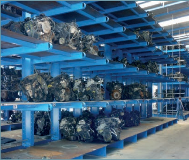
Almacenamiento de motores en estanterías cantilever robustas. Por el uso de puentes entre brazos pueden almacenarse una gran cantidad de diferentes tamaños en cada nivel.
