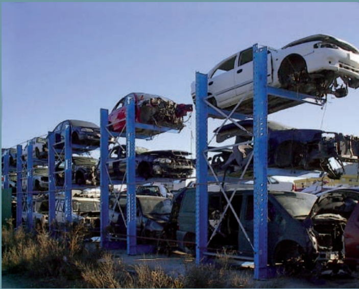
Estanterías cantilever compactas para el almacenamiento de vehículos fuera de uso al aire libre. No se crea oxido escondido ya que son materiales macizos
