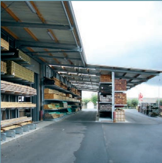
Nave autoportante completamente cerrada con anexo adicional abierto de una fila de estantería cantiléver de ambos lados y techada. Incl. iluminación y bandas de iluminación sobre el paso.
