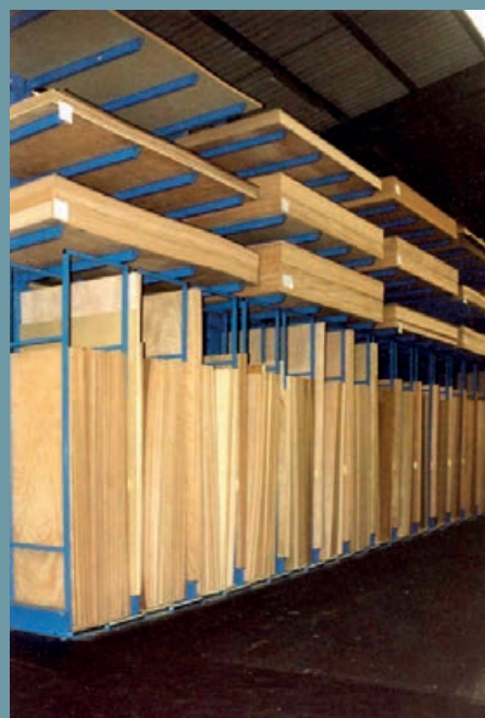
Combinación de estanterías cantilever con estantería de tableros integrada. Alta densidad de almacenamiento sobre poca superficie utilizada
