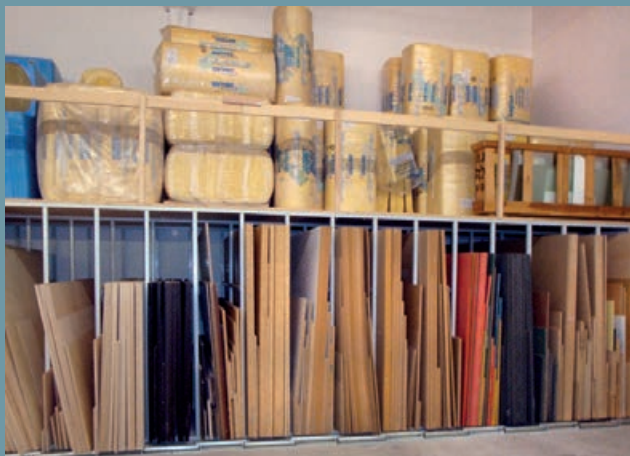
Almacenamiento vertical de tableros aglomerados con uso de la parte superior como zona de almacenamiento adicional
