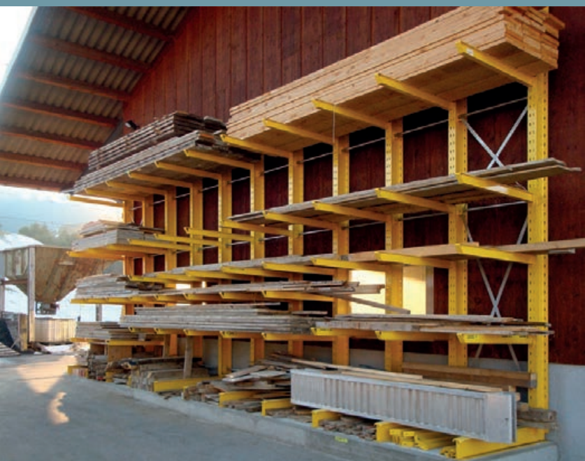
Almacenamiento de mercancías largas debajo del alero de la carpintería. Diferentes mercancías y medidas almacenadas en orden y seguras en una estantería cantilever
