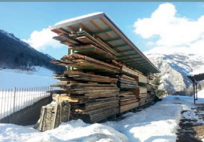
Estantería cantilever con techo en una carpintería. Almacenamiento óptimo en el exterior
