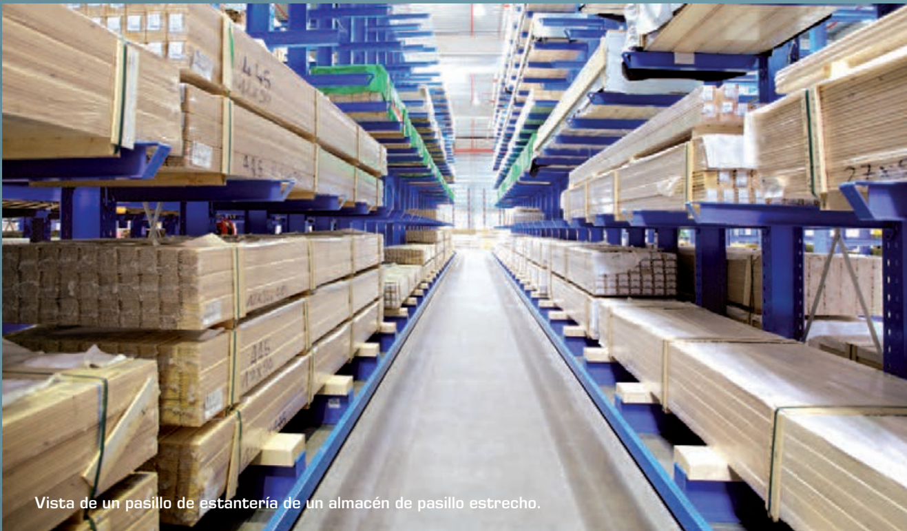
Estanterías cantilever dobles para el almacenaje de madera de diferentes gamas.
