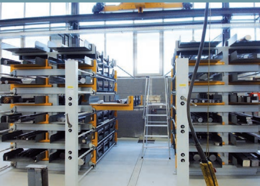
En las estanterías cantiléver telescópicas, se desplazan niveles completos de almacenamiento por medio de husillos giratorios. Óptimo para la manipulación por grúa con anchura mínima del pasillo
