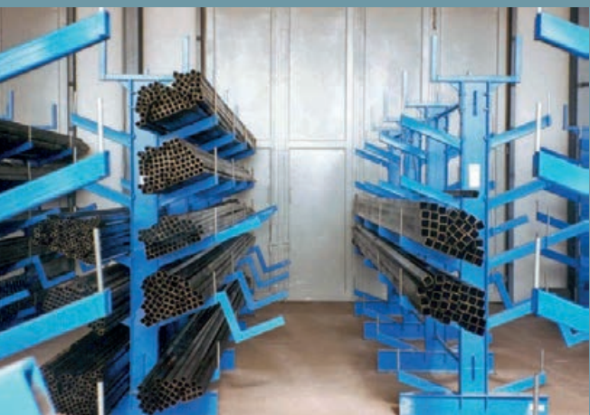
Estanterías cantiléver para el almacenamiento con puente-grúa. Manipulación por medio de un prolongador de almacenamiento y otro de expedición.
