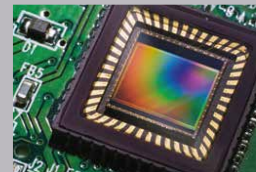
CMOS传感器和高分辨率特制镜头
