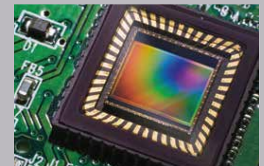
CMOS-Sensor und speziell konzipiertes Objektiv für eine hohe Auflösung
