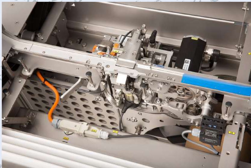
Interior de la flejadora. Cabezal de sellado
